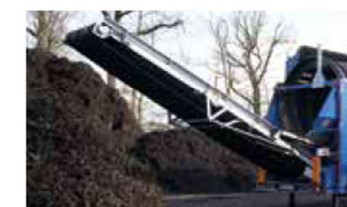
Rozšírený pás na hrubú frakciu, výška vynášania až 3800 mm
