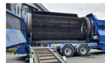
Jednoduchá výmena bubna vďaka priemeru 2000 mm
