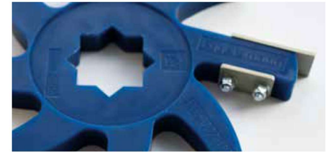
Hviezdicové sito na hrubé triedenie s ochranným prvkom proti opotrebovaniu
