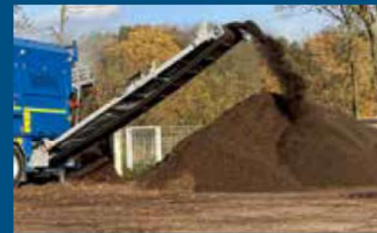
Dlhé pásy - pre väčšiu výšku vysunutia
