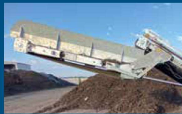
Pás na kamene - na vytriedenie kameňov a ťažkých nečistôt
