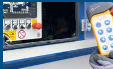
Diaľkové ovládanie - na ovládanie z kolesového nakladača
