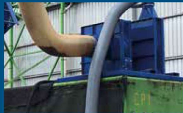
AIRFIX - vzduchové zariadenie na odstraňovanie fólií a ľahkých nečistôt
