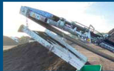
Magnetické valce - na vytriedenie železa na vynášacom páse
