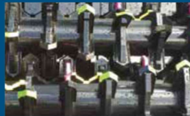
FORUS: bez nástroja vymeniteľné sekundárne trémie pre dosiahnutie rôznych veľkostí frakcie
