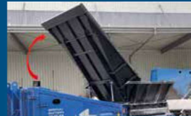
Automatizácia násypky (FORUS) - pre automatickú optimalizáciu nakladania
