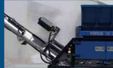
Hydraulicky výškovo nastaviteľný neodýmový magnetický separátor
