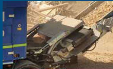
Výkonný neodýmový magnetický separátor, hydraulicky nastaviteľná výška, obojstranné odstraňovanie kovového šrotu
