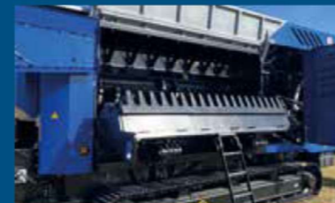
Drviaca klapka - možnosť hydraulického nasadenia = voľný prístup do priestoru drevenia
