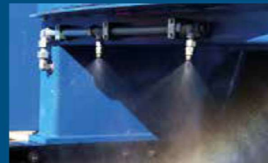
Zariadenie na zvlhčovanie materiálu – na zadržiavanie prachu
