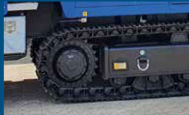
Robustné pásové podvozky, 2 rýchlosti, ochranné článkové pásy
